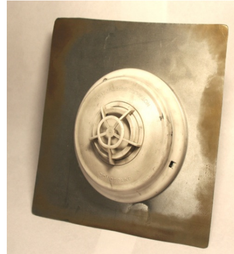
Det B Thermistor 47°C (117°F) 57°C (135°F)
